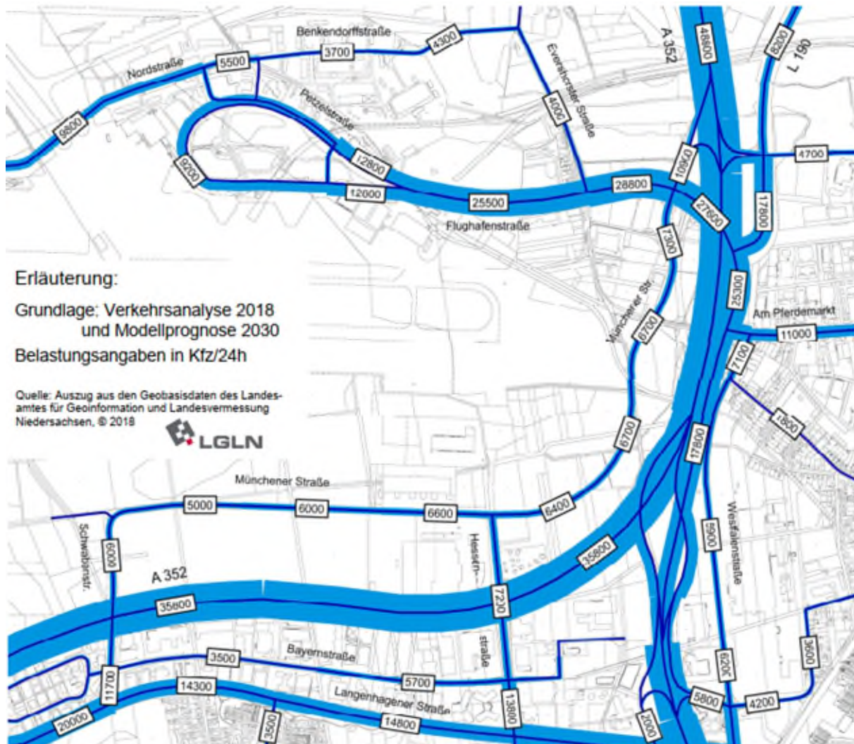
Abbildung 2: Prognosebelastung im Planungsnullfall (ohne Sondergebiet Multifuel-Autohof), Verkehrstechnische Untersuchung zum Baugebungsplan Nr. 86N, September 2022 [1]
