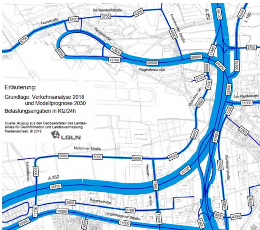
Abbildung 4: Prognosefall für das Planungsgebiet mit Multifuel-Autohof, Verkehrstechnische Untersuchung zum Bebauungsplan Nr. 86N, September 2022 [1]
